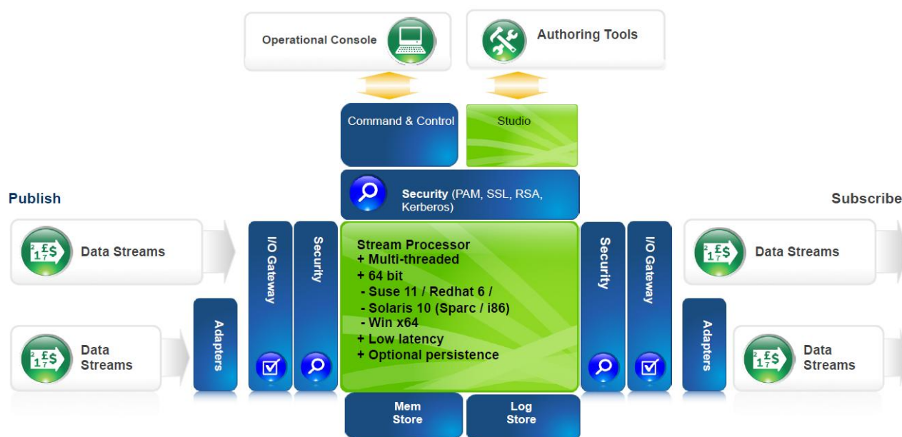
Рис. 13. Обобщённая архитектура SAP Sybase Event Stream Processing
